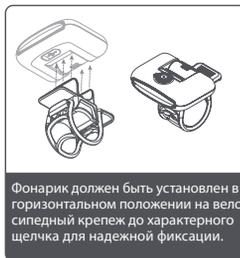
Фонарь должен быть установлен в горизонтальном положении на велосипедный крепеж до характерного щелчка для надежной фиксации.
